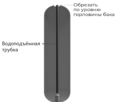
Обрезка водоподъемной трубы
